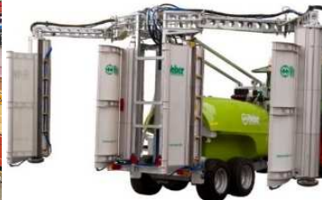
WEBER – descentes avec panneaux récupérateurs
