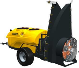
Calvet - Voûte double turbine linéaire
