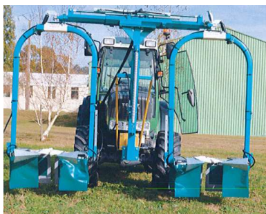
DHUGUES - tunnel d'épamprage
